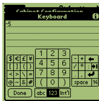
Étape 5: Tapez sur la ligne de numéro à côté de la plaque à décaler, puis sur l'icône du numéro (cf. Figure 1, page 3-5) en bas à droite de l'affichage du Palm. Utilisez la touche de retour arrière pour effacer le nombre dans le champ et utilisez le pavé numérique pour entrer le décalage souhaité. Voir les exemples du tableau 1 (à droite). Tapez sur Done.
